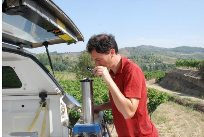
Imatge 6: Tècnic de VITEC mesurant l'estrès hídric
